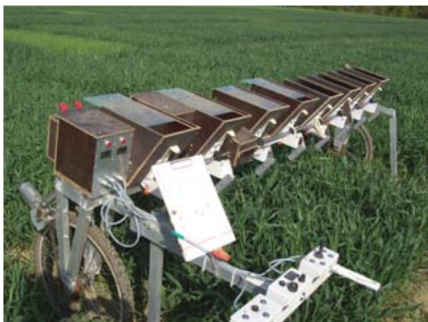
Abb. 2: Parzellendüngerstreuer (Eigenentwicklung) zur Applikation von granulierten Mineraldüngern in Exaktversuchen
