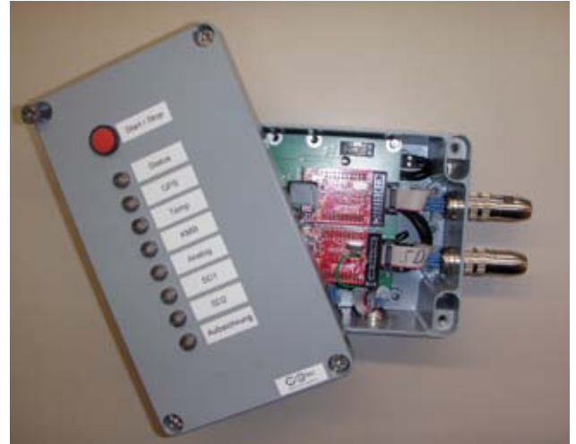
Abb. 1: Messtechnik BOs-1EP, das hochschuleigene geoelektrische Messsystem zur Erfassung des komplexen elektrischen Leitwertes
