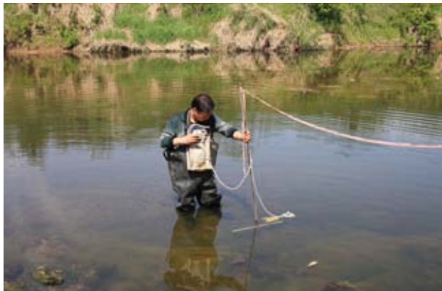
Abb. 2: Messung der Wasserfließgeschwindigkeit im FengLe-River
