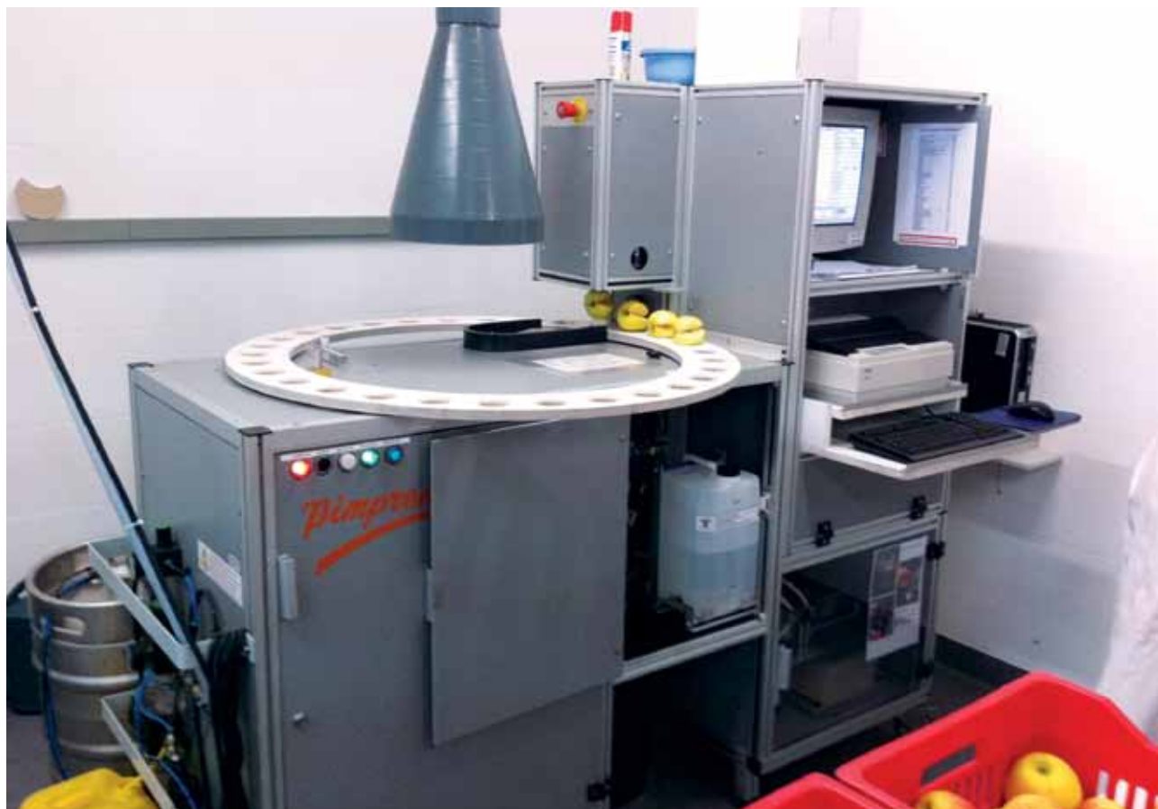
Abb.: Destruktive Messung der Fruchtfleisfestigkeit, der löslichen Trockensubstanz, des Säuregehaltes und der Saftigkeit mittels der Pimprenelle. Beim Konsumententest wurde den Äpfeln bereits ein 1/8-Segmet entnommen.
