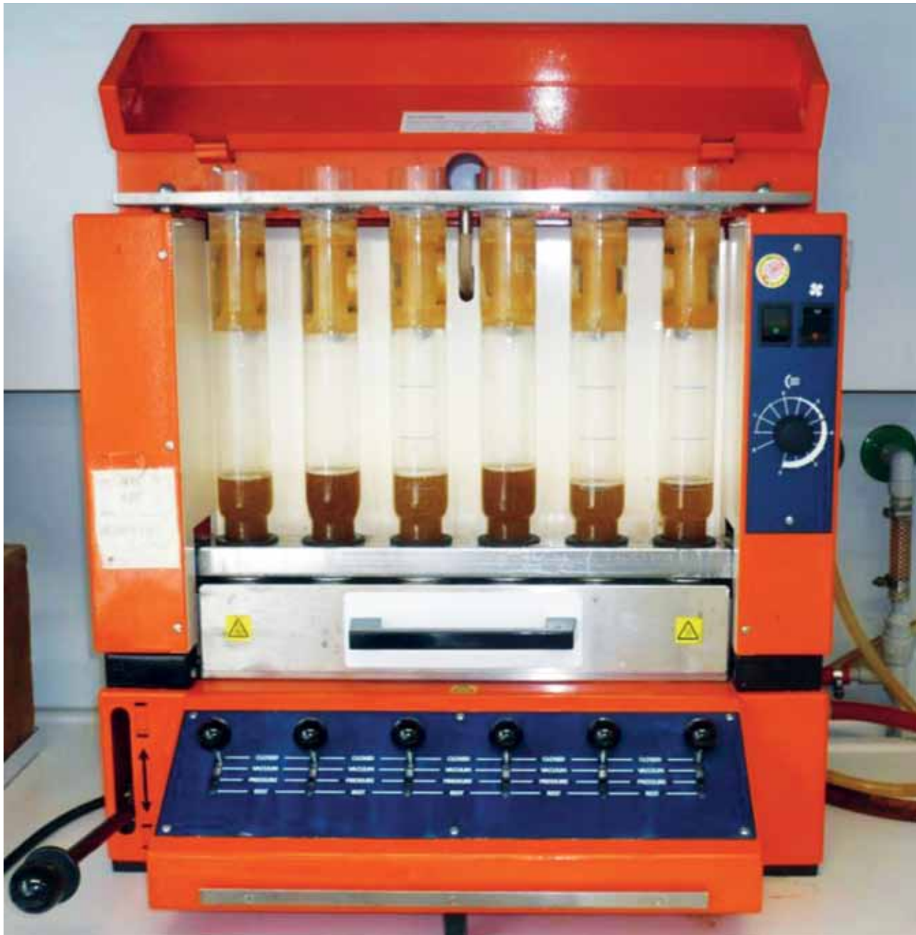
Abb. 1: Aufschluss der NDF - Heißextraktionsapparat
