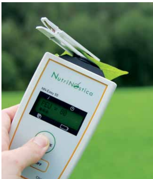
Abb.: Chlorophyllfluoreszenzmessung mit dem NN-Easy 55 zur Erfassung des Mangan Versorgungszustandes
