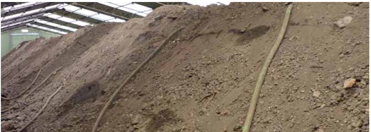
Abb. 2: Mikrobiologische Mietensanierung von phenolhaltigem Gießereialsand
