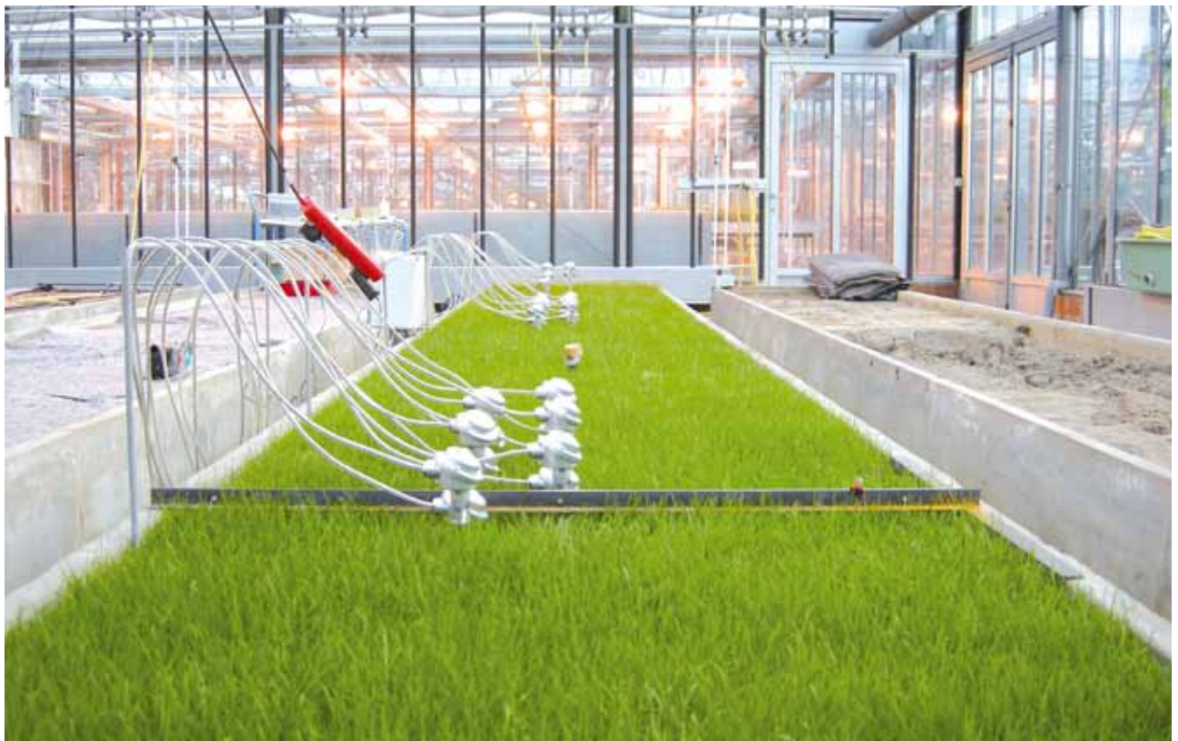
Abb. 3: Versuchsaufbau mit bodenphysikalischen Messgeräten im Gewächshaus der Hochschule Osnabrück
