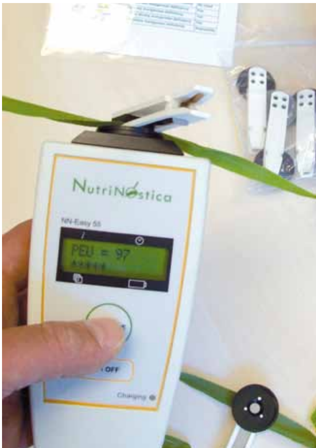
Abb.: Messung des Mangan-Status von Wintergerstenblättern mit dem Mangan-Tester NN-Easy55
