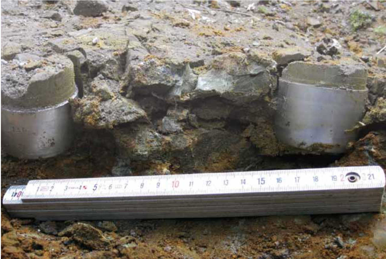
Abb.: Verwendung von Steckzylindern zur naturnahen Probenahme (Foto: L. Makowsky)
