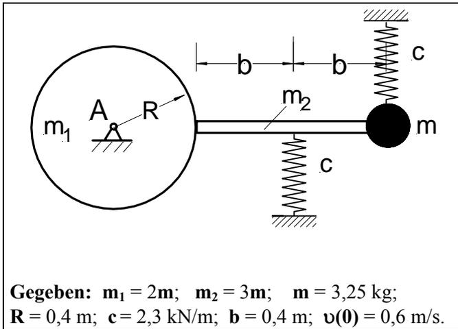
**Aufgabe 6.7:** An einer drehbar gelagerten Kreisscheibe der Masse  $m_1$  ist wie skizziert eine Stange der Masse  $m_2$  befestigt. Am Ende der Stange sitzt eine Punktmasse  $m$ . Die Kopplung der Stange mit zwei Federn (Federkonstante  $c$ ) macht das Gebilde schwingfähig. Die gezeichnete Lage ist die Ruhelage des Systems. Um das System aus der Ruhelage in die Bewegung zu versetzen, wird der Punktmasse in der gezeichneten Lage die Anfangsgeschwindigkeit  $v(0)$  mitgeteilt.
