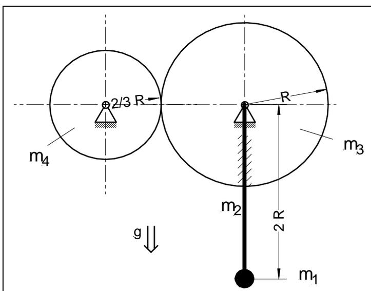
**Aufgabe 6.9:** Das nebenstehend gezeichnete schwingungsfähige System besteht aus zwei Kreisscheiben (Masse  $m_3$  und  $m_4$ ). Die Scheibe mit Masse  $m_3$  treibt die Scheibe mit Masse  $m_4$  durch Reibung an. Die Reibung ist so groß, dass kein Rutschen entsteht. An der Scheibe mit Masse  $m_3$  ist ein Stab (Masse  $m_2$ ) der Länge  $2R$  angeschweißt, an dessen Ende sich die Punktmasse  $m_1$  befindet.
