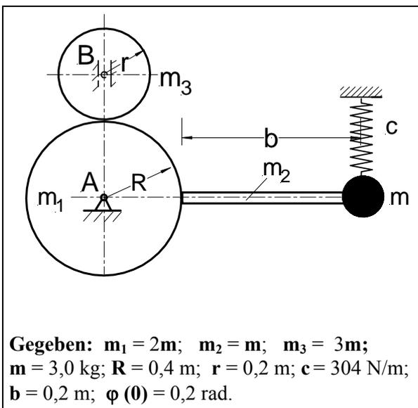
**Gegeben:**  $m_1 = 2m$ ;  $m_2 = m$ ;  $m_3 = 3m$ ;  $m = 3,0 \text{ kg}$ ;  $R = 0,4 \text{ m}$ ;  $r = 0,2 \text{ m}$ ;  $c = 304 \text{ N/m}$ ;  $b = 0,2 \text{ m}$ ;  $\varphi(0) = 0,2 \text{ rad}$ .
