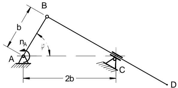
**Aufgabe 2.2:** Die Kurbelwelle des nebenstehend gezeichneten Getriebes dreht sich um den Punkt **A** mit der konstanten Drehzahl  $n_k$ . Die Lager **A**, **C** und **E** befinden sich auf der gleichen Höhe.
