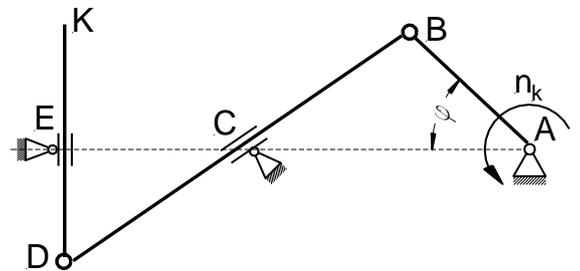
**Aufgabe 2.3:** Die Kurbelwelle des nebenstehend gezeichneten Schubkurbelgetriebes dreht sich um den Punkt **A** mit der konstanten Drehzahl  $n_k$ . Im Punkt **D** ist gelenkig eine Stange **DE** befestigt, die bei **E** in einer drehbaren Führung gelagert ist.
