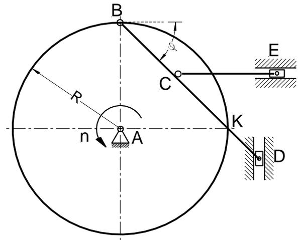
**Aufgabe 1.10:** Das skizzierte Getriebe dreht sich mit der konstanten Winkelgeschwindigkeit  $\omega_A$ . Der Gelenkpunkt **C** bewegt sich auf einer geraden Bahn, der Gelenkpunkt **D** auf einer Kreisbahn mit dem Radius **R**.
