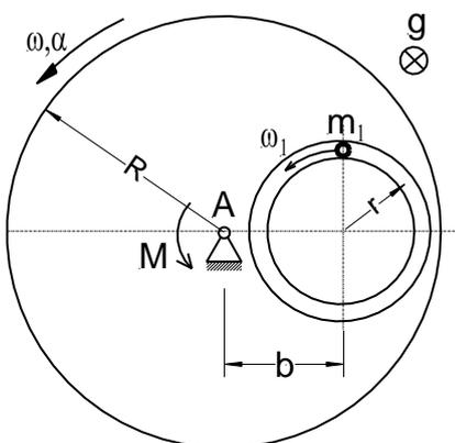
**Aufgabe 2.12:** In einer Kreisscheibe (Radius **R**, Massenträgheitsmoment  $J_A$ ) ist eine kreisförmige Nut mit dem Radius **r** ausgefräst. In der Nut befindet sich eine Punktmasse  $m_1$ , die sich mit der konstanten Winkelgeschwindigkeit  $\omega_1$  um den Mittelpunkt der Nut reibungsfrei dreht. Die Kreisscheibe selbst dreht sich um eine vertikale Achse **A** mit der Winkelgeschwindigkeit  $\omega$  und der Winkelbeschleunigung  $\alpha$ .
