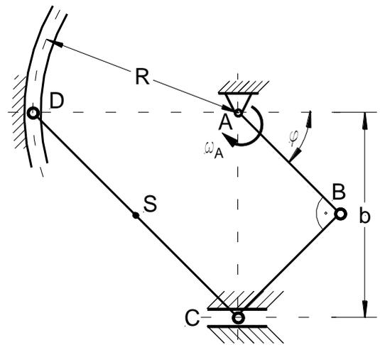
**Aufgabe 1.11:** Die dreieckige starre Scheibe **BCD** des nebenstehend skizzierten Schubkurbelgetriebes wird durch die Drehbewegung der Kurbel **AB** angetrieben. Die Kurbel dreht sich um den Punkt **A** mit der konstanten Drehzahl  $n_A$ . Man bestimme für die skizzierte Getriebebestellung:
