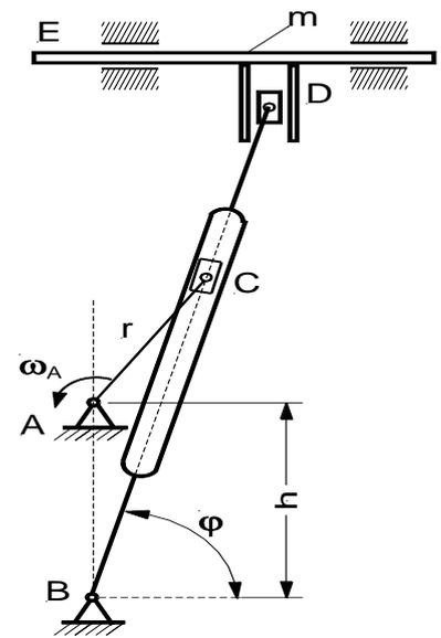
**Aufgabe 2.11:** Die Kurbel **AB** (Länge **r**) der dargestellten Anordnung wird mit **konstanter** Winkelgeschwindigkeit  $\omega_A$  angetrieben, dadurch werden eine rechteckige Platte und die Schwinge **CD** in Bewegung versetzt. Der Gleitstein **E** gleitet reibungsfrei in der Führungsnut der Platte mit der Geschwindigkeit  $v_{rel}$  und der konstanten Beschleunigung  $a_{rel}$ .
