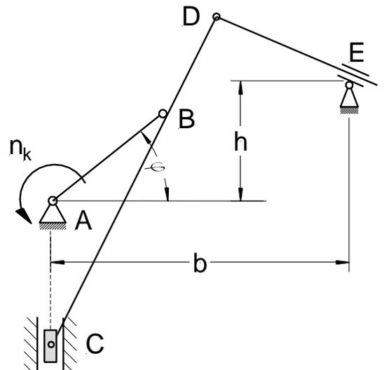
**Aufgabe 2.4:** Die Kurbelwelle des nebenstehend gezeichneten Getriebes dreht sich um den Punkt **A** mit der konstanten Drehzahl  $n_k$ . Im Punkt **D** ist gelenkig ein Gleitstein **D** montiert, der in der Nut der im Punkt **E** gelagerten Schwinde **EF** gleiten kann.
