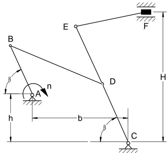
**Aufgabe 1.16:** Das dargestellte Getriebe besteht aus zwei Kreisscheiben und zwei Stangen. Die größere Kreisscheibe ist fest befestigt. Die Kurbel **1** dreht mit konstanter Drehzahl **n** um **A**, damit wird die zweite Kreisscheibe in Bewegung versetzt. Diese Bewegung wird über die Stange **2** in eine vertikale Bewegung des Punktes **D** umgesetzt.
